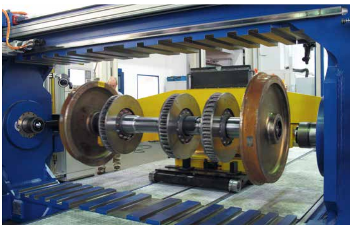
Zuverlässig und technisch ausgereift: Beladung einer Radsatzpresse
