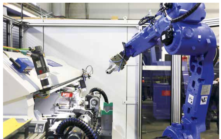
Hoher Automatisierungsgrad: Richtmaschine mit Roboterbeladung im Einsatz
