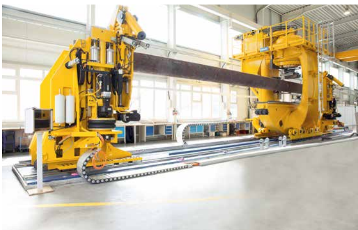
Setzt Maßstäbe: Großteilrichtanlage ADSV4000 mit einer Kapazität von 4.000 t
