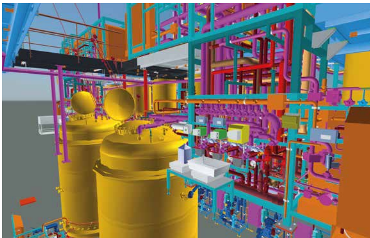
Komplexe Technologie: 3-D-Modell einer biopharmazeutischen Produktionsanlage
