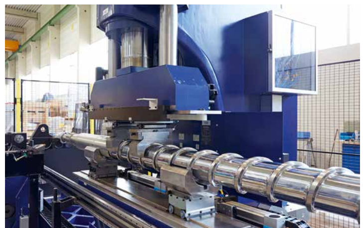
Präzisionsarbeit: Richten von Extruderschnecken
