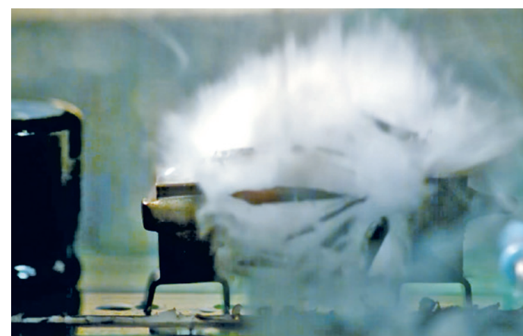
Ausgelöst: Die E-Bulb (Extinguishing Bulb) erkennt Funken und Feuer in elektrischen Geräten, löscht sie und verhindert so größere Schäden
