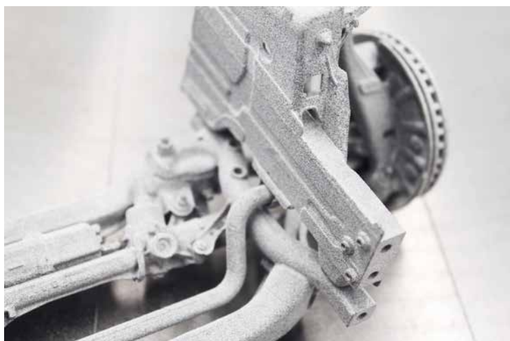
Komplexes 3D-gedrucktes Funktionsbauteil aus PA12
