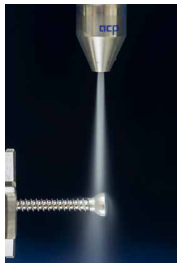
Das quattroClean-System kommt in der Medizintechnik für die Endreinigung unterschiedlicher Produkte zum Einsatz
